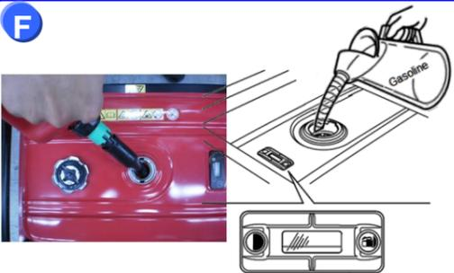
Coloque Gasolina nueva al tanque sin exceder el cuello del tanque a fin de que esta no se derrame
